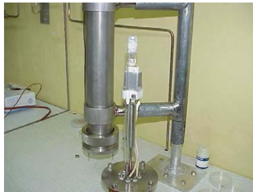
Fig. 4 Arreglo experimental para el crecimiento de CaF 2 empleando hidrógeno atómico
