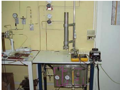
Fig. 6 Sistema de crecimiento completo empleando hidrógeno atómico
