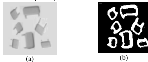
Figura 6. Resultados de la detección de bordes y umbralización. (a) Imagen original. (b) Simulación postsíntesis con la arquitectura desarrollada.
